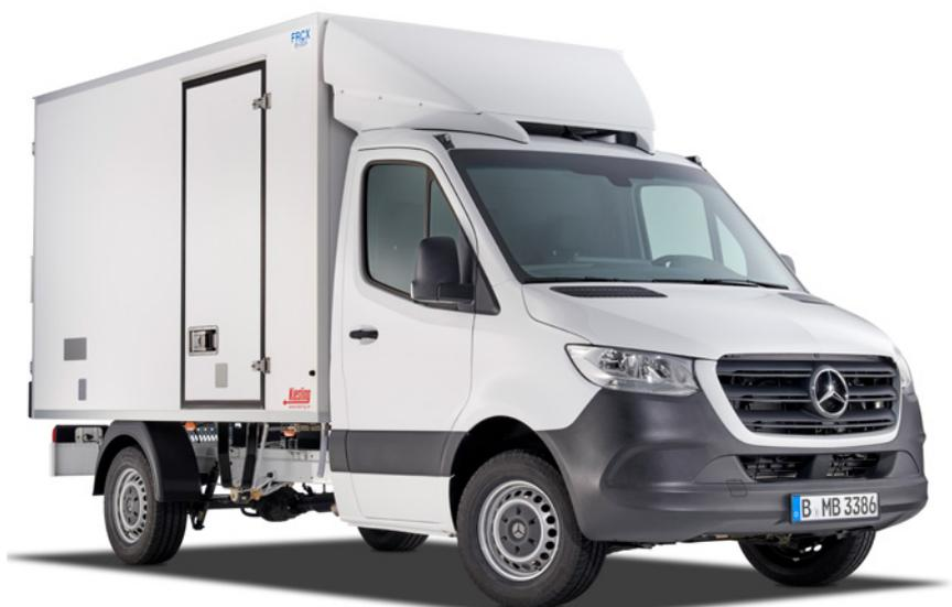
Als Serie ist der Kühlkoffer mit einem Thermo King V-200 MAX ausgestattet für einen Temperaturbereich bis 0 °C (Frischdienst).
