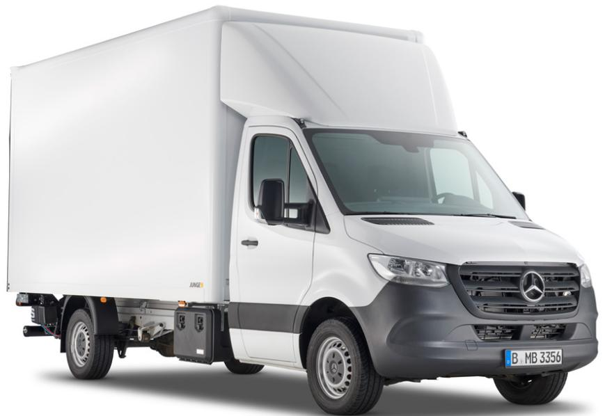
Der Kofferaufbau von der Junge Fahrzeugbau GmbH: verfügbar für die Mercedes-Benz Sprinter Fahrgestelle Standard und lang mit einem zGG von 3.500–5.500 kg.
