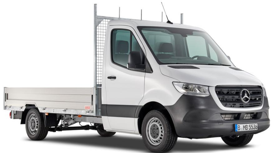
Die Seitenwände sind rundum vollständig abklappbar.
